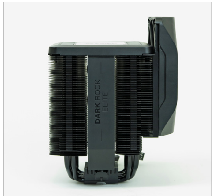
Bei derart großen Kühlern muss oft der Frontlüfter nach oben verschoben werden um Platz für RAM-Riegel zu schaffen.
