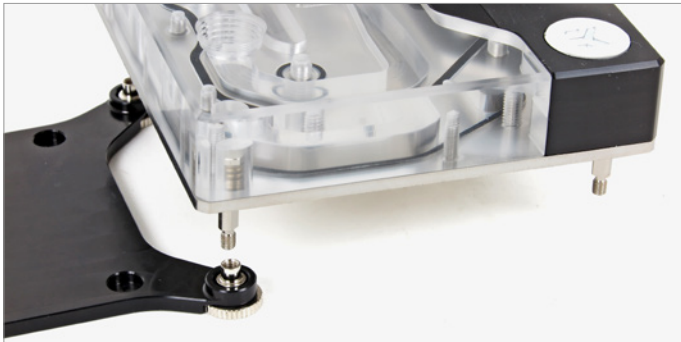
Versteckte Befestigung beim Velocity²: Eine nicht drehbare, aber gefederte Schraube ragt aus dem Kühler durch das Mainboard in eine Rändelmutter in der Backplate.
