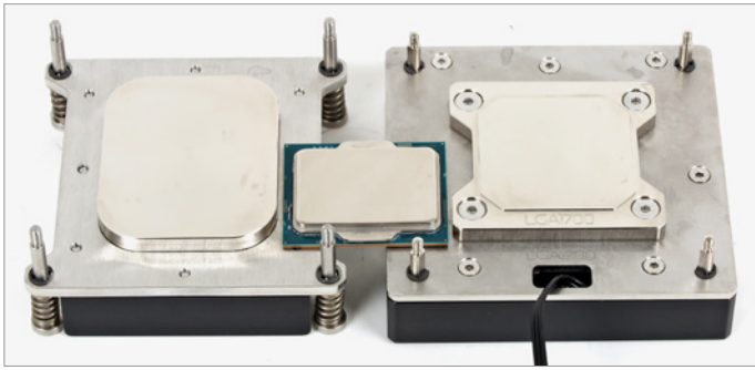
Die Streckung der Bodenplatte des EK-Pro (links; Velocity² zum Vergleich rechts) ist keine Anpassung an den LGA1700; tatsächlich würden 2 CPUs quer darauf passen.
