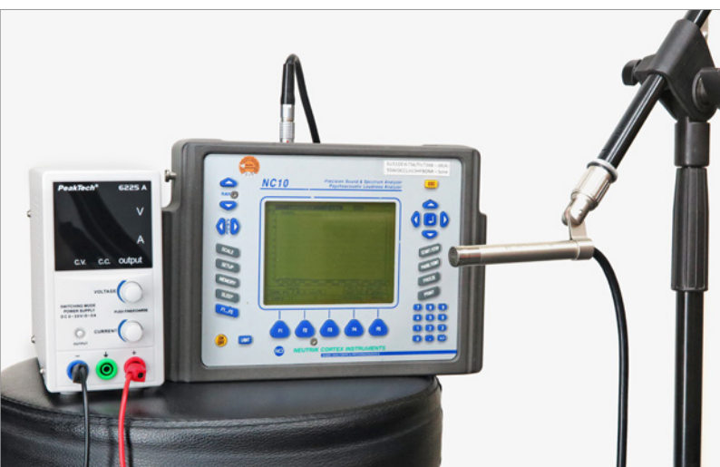
Mithilfe des Labornetzteils und des Cortex NC10-Messmikrofons nehmen wir eine Lautheitsnormierung der Lüfter vor.
