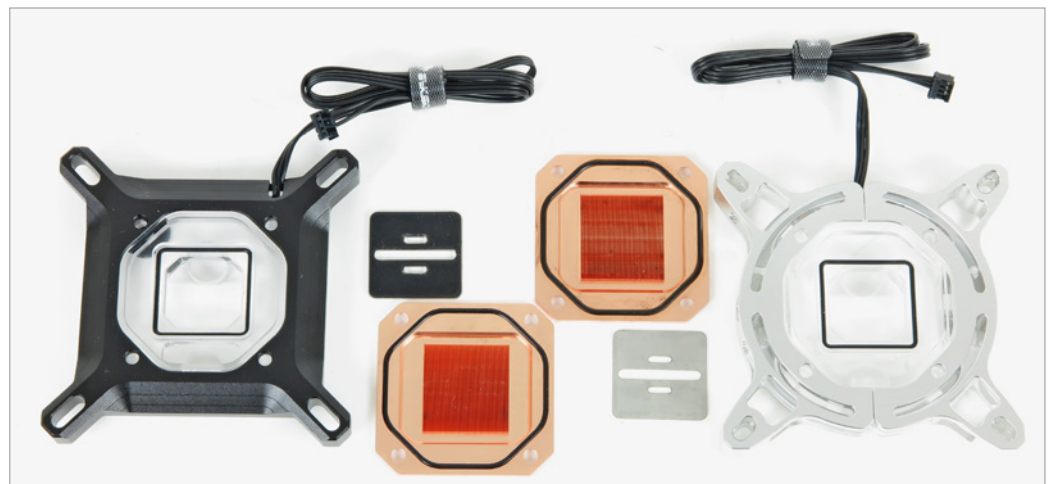
Von oben sehen die Kühlbereiche von Bykski und Granzon identisch aus. Tatsächlich hat ersterer aber eine zusätzliche Gummidichtung, letzterer zwei Lamellen extra.
