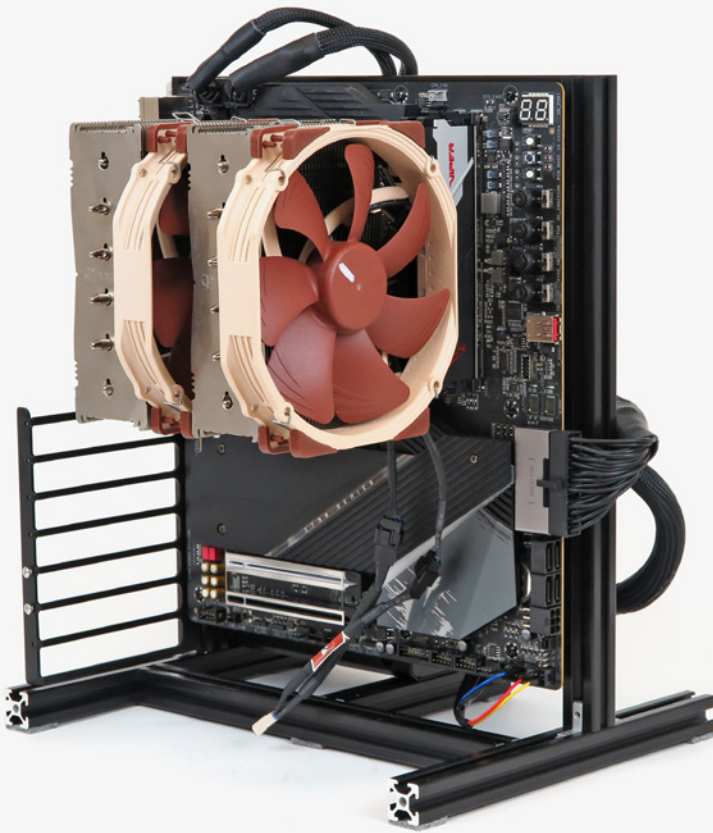
Das vertikale Testsystem unterstützt, genau wie der standardmäßige Aufbau in einem Gehäuse, die natürliche Konvektion der warmen Luft.
