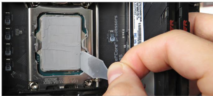
Als Wärmeleitpaste kommt Arctic's MX-6 zum Einsatz. Wir tragen die Paste gleichmäßig auf, um für jeden Kühler die gleichen Bedingungen zu schaffen.
