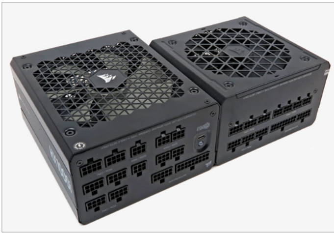
Zum Vergleich: Das HX1000i 2023 ist mit seinen 18 cm rund 4 cm länger als das RM1000e. Üblicherweise spielt das nur bei kleineren Gehäusen eine Rolle.
