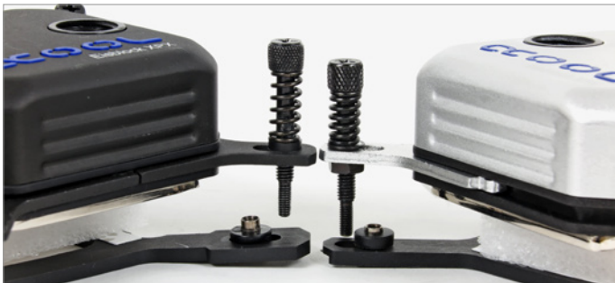
1 Cent gespart? Bei Alphacools ursprünglicher XPX-Halterung (rechts) fixierte eine Kontermutter unter der Halterung alle andere Teile und spannte die Feder vor.
