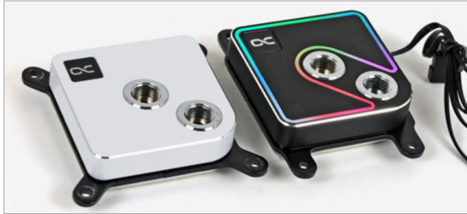
Bei der Aurora-Version des Core 1 ist der Messing-Deckel hohl und mit Aluminium abgedeckt, um einen durchsichtigen Kunststoffstreifen zu beleuchten.
