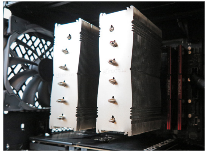
AMD empfiehlt zwar eine AiO, doch mit dem wuchtigen Doppel-Turm-Kühlkörper des NH-D15 kühlen wir unseren Ryzen 7 7800X3D einfach passiv.
