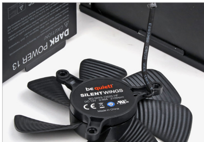
Die Titanium-Marke Dark Power 13 setzt auf einen „rahmenlosen“ Lüfter mit brummigen Nebengeräuschen. Die Propellerbasis wird an drei Punkten fixiert.
