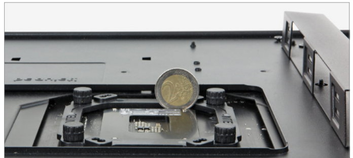
ATX-Spezifikationen erlauben 5 mm hohe Objekte auf der Mainboard-Rückseite. Das entspricht ungefähr der Asus-Backplate – Thermaltakes Halterung misst 14,3 mm.
